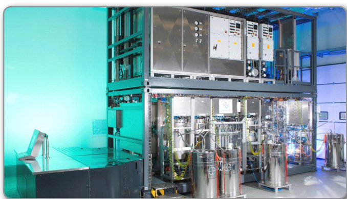
Modulare Anlage zur Herstellung eines pharmazeutischen Intermediaten.
