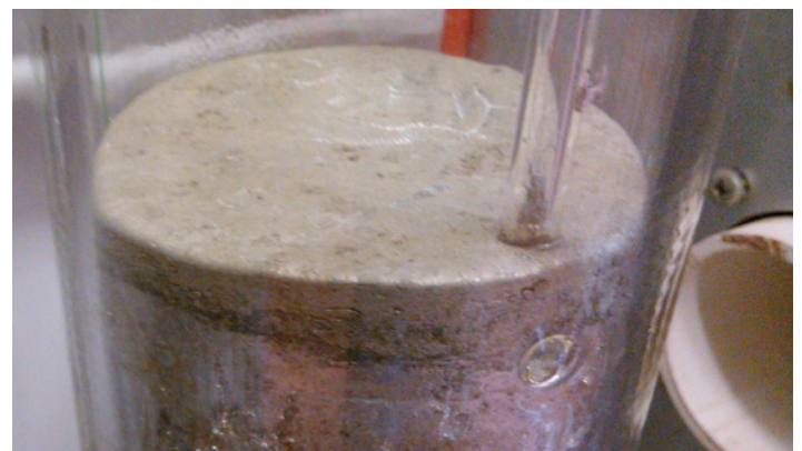
Fotoaufnahme eines Quarzglas-Vorratsgefäßes vom Gas-Flüssig-Pfropfenströmung-Kapillarreaktor
