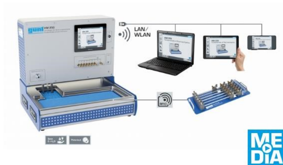
Abbildung 1: Strömungsmechanischer Versuchsstand mit Remote-Learning-Option
