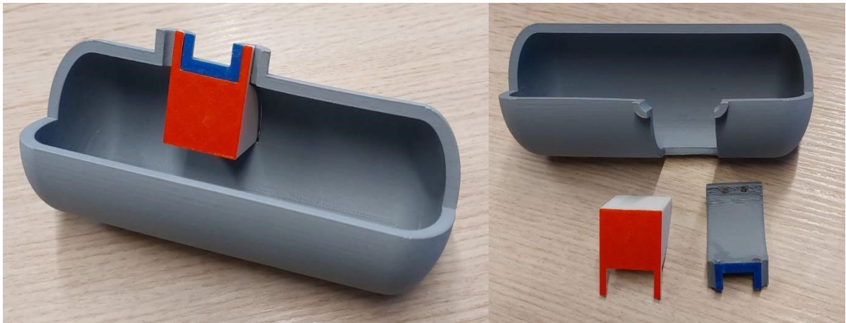
Abb. 5: 3D-gedrucktes Modell eines Drucktanks mit zwei Anschlussstutzen und abnehmbaren Teilen, um das Flächenvergleichsverfahren zu veranschaulichen. Die abnehmbaren Teile werden über Magnete fixiert.
